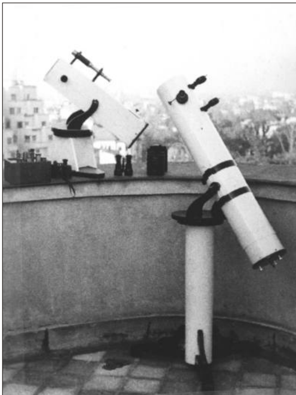
Telescop Newton azimutal de 150 mm (oglină Seidel la F/D=7 ) pe montură din lemn sistem Nicklitchek. Telescop Newton de voiaj de 110 mm. Oculare și un binoclu primitiv. Un singur căutător pentru ambele instrumente.
