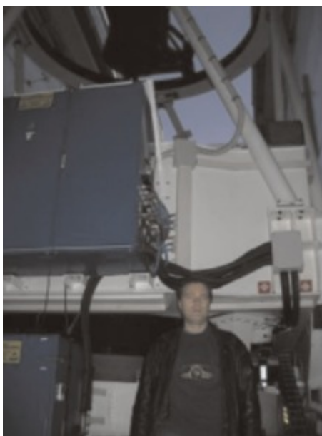
O imagine de ansamblu a telescopului Galileo (TNG) ; pentru a avea o idee de dimensiuni, am adaugat o fotografie « eu cu telescopu' ». In cutiile albastre sunt concentrate componentele opticii adaptative
