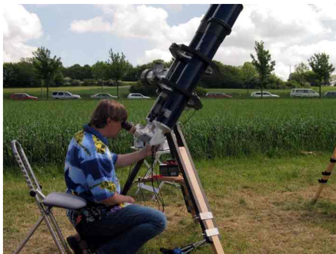
Ce se poate face cu un dobson e binele posibil și la refractoare: un binocular gigantic din două refractoare de 152mm, f/8.
