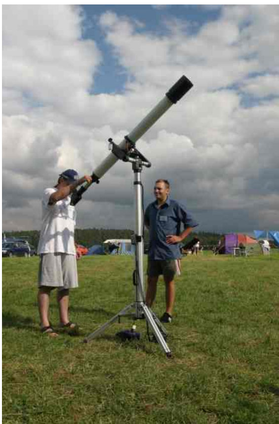
Refractorul meu de 102mm f/15 cu prismă Herschel pentru observarea Soarelui (cel în cămașă albastră lângă telescop sunt eu).
