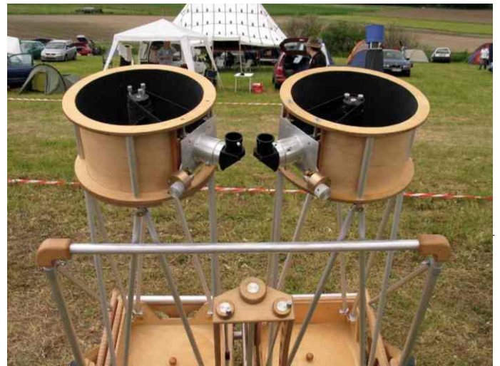
Unor persoane nu le ajunge să aibă un dobson truss. Soluția: un bino-dobson truss, în acest caz cu oglinzi de 10 inches.
