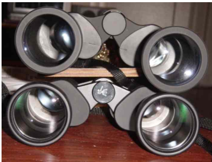
Cele două binoculi puse unul peste altul și fotografiate din fața. Scenix este cel de jos. Se observă culoarea acoperirilor antireflex de pe prima suprafața optică a obiectivelor.
