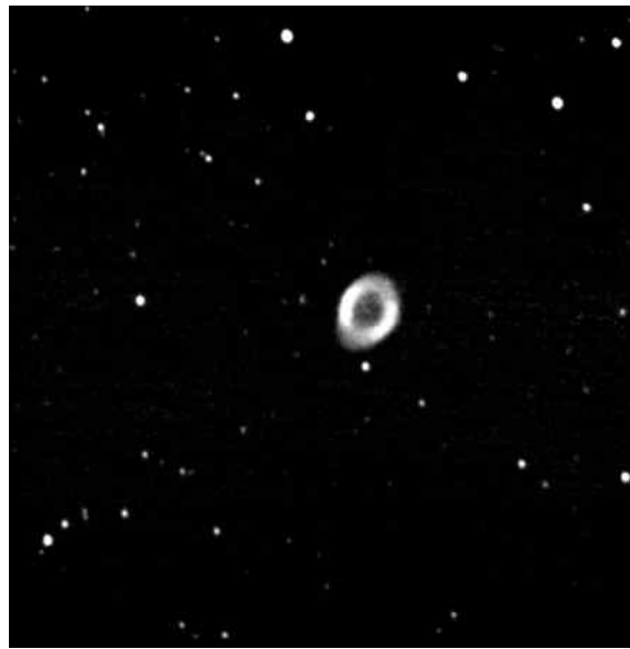
M57 - prima imagine luata prin telescopul LXD55 de 254 mm diametru. Se observa steaua centrală a nebuloasei. Magnitudinea stelara limita este 16,5. Medie a 54 de imagini a 10 secunde expunere. Data - 14 mai 2005. Ivo Dinev si Adrian Sonka
